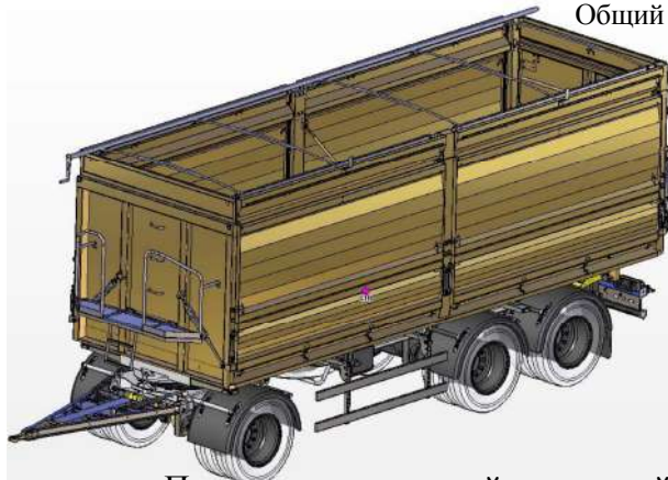
Прицеп самосвальный трехосный с механическим запорным механизмом 7200
