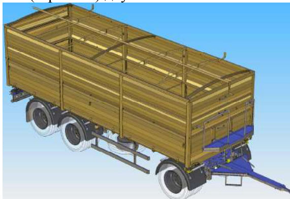
Прицеп бортовой 7200 (зерновоз) трехосный с механическим запором
