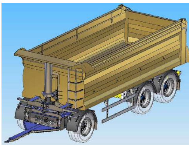
Прицеп самосвальный 6100 трехосный задней разгрузки с механическим запором открывающимся автоматически
