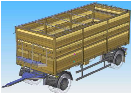
Прицеп бортовой (зерновоз) двухосный с механическим запором 6200
