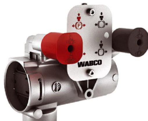
Рис. 13. Воздухораспределитель комбинированный с функцией растормаживания.
