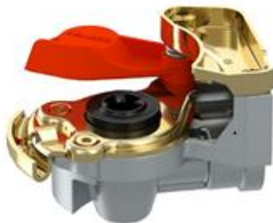
Рис. 30. Головка «ПАЛМ» автоматическая, с красной фиксируемой крышкой, для питания магистрали тормозной системы Wabco 952 201 0120, SORL 3521 014 0010, TCP 952 201 0120
