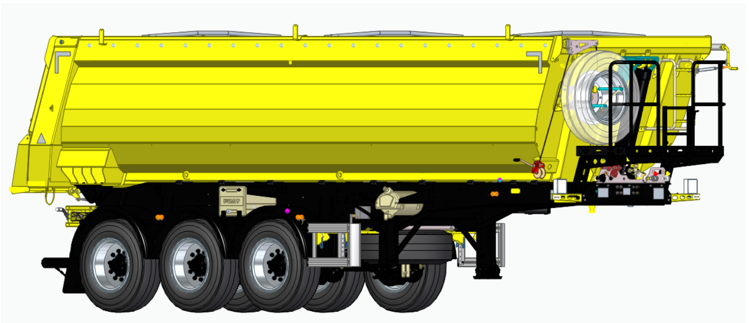
Рис. 5. Полуприцеп-самосвал модели 924900-30Н1. Общий вид. Платформы стальной типа Half-Pipe.
